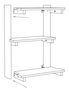
Befestigen Sie die Regale an den Seitenteilen, indem Sie die kurzen Schrauben (E) durch die Löcher in den Regalen und in die Seitenteile mit dem Inbusschlüssel (F) schrauben.
