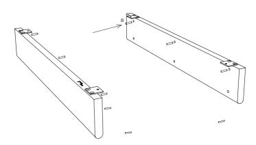
Drehen Sie die Seitenteile, sodass die Scharniere nach unten zum Boden zeigen. WICHTIGER HINWEIS: Achten Sie darauf, dass die Markierung "right" auf der Seite des Seitenteils nach unten und nach rechts zeigt, wo das untere Regal am Seitenteil befestigt werden soll, und dass die Markierung "left" auf dem anderen Seitenteil nach unten und nach links zeigt. Schieben Sie dann das mittlere Regal zwischen die Seitenteile und stellen Sie sicher, dass die Holzdübel in die Rillen des Regals passen.
