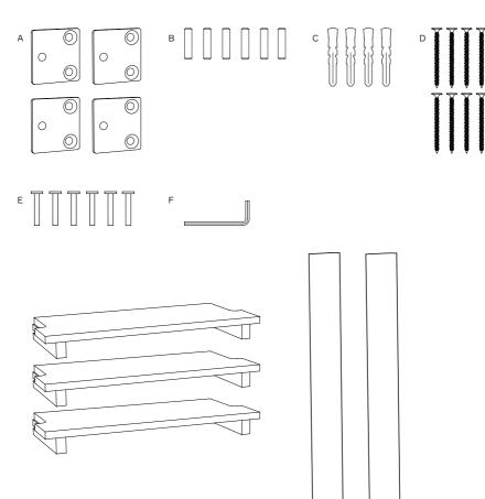
Legen Sie die Seitenteile auf den Boden und stellen Sie sicher, dass sie richtig ausgerichtet sind. Verwenden Sie einen Schraubenzieher oder eine Bohrmaschine, um die Scharniere (A) mit den langen Schrauben (D) an den Seitenteilen zu befestigen.
