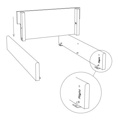
Befestigen Sie das Regal an den Seitenteilen, indem Sie die kurzen Schrauben (E) durch das Loch im Regal und in die Seitenteile mit dem Inbusschlüssel (F) schrauben.
