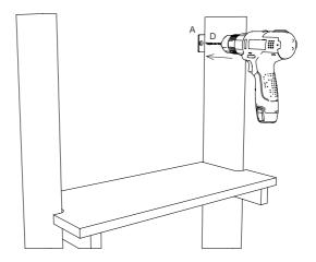
Schieben Sie dann die beiden verbleibenden Regale zwischen die Seitenteile und stellen Sie sicher, dass die Holzdübel in die Rillen jedes Regals passen.
